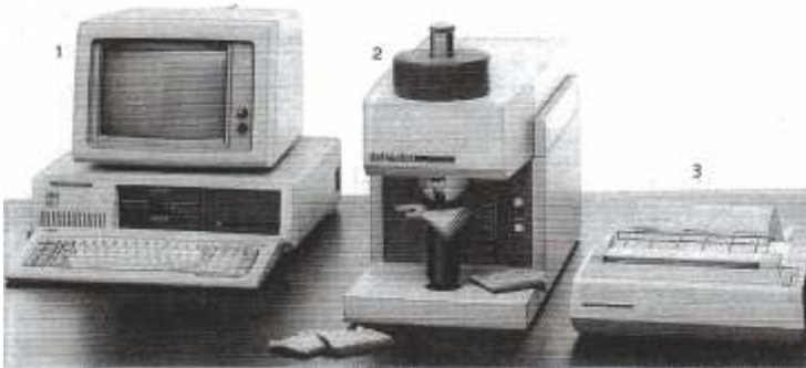
Slika 4: Aparaturni sistem za barvno metriko. 1 - računalnik z monitorjem, 2 - spektrofotometer, 3 - tiskalnik (vse iz leta 2001/2004).
