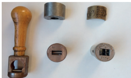
Surovca za izdelavo strojnega in datumskega žiga (v sredi zgoraj in spodaj), desno zgoraj primerek polkrožnega strojnega žiga s sloganom in desno spodaj izgraviran dnevni žig, levo žig z lesenim ročajem, a brez datumskega mehanizma (foto I. Pirč).
